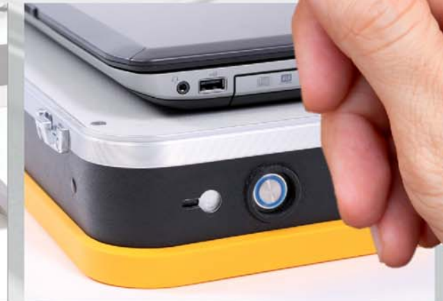
Der Einschaltknopf wurde versenkt, um ein versehentliches Ausschalten zu verhindern.
